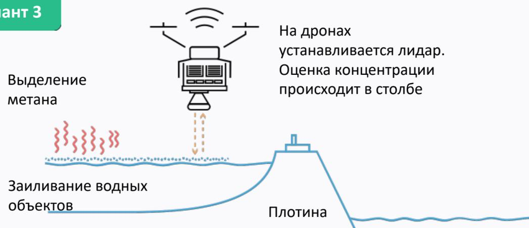
Инструментальные замеры поглощающей способности и выбросов углеродных единиц (в кг) малогабаритной установкой, прикрепленной к дрону. Используется для поиска аварийных выбросов, заиленных водоёмов или утечек из трубопроводов.
