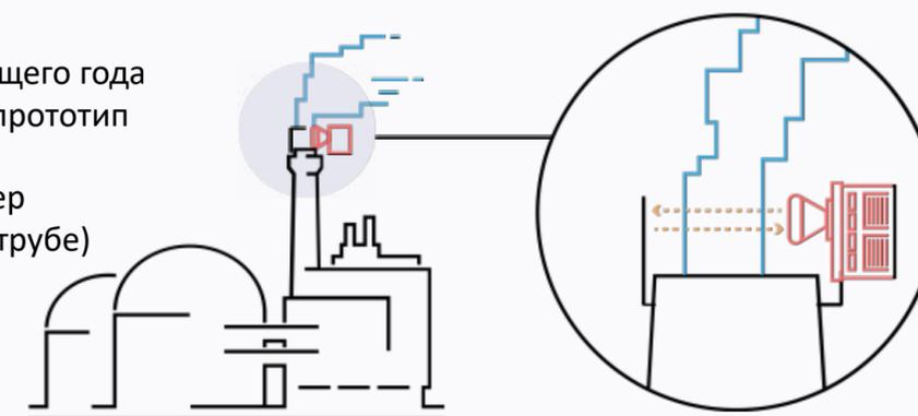
Инструментальные замеры и выбросов углеродных единиц (в кг) и загрязняющих газов прибором, устанавливаемом на трубе.
