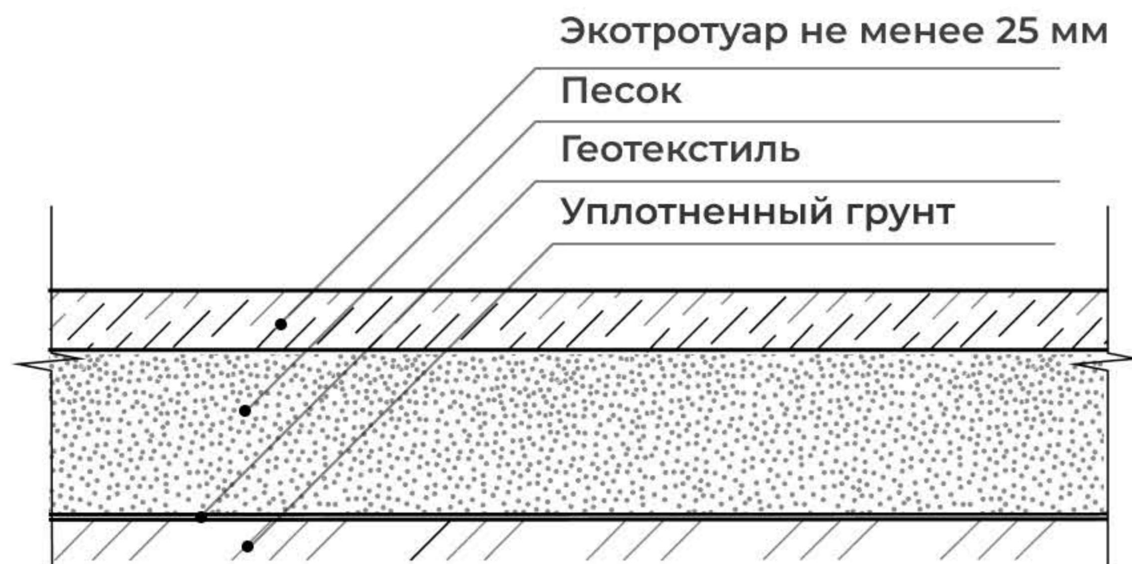
**8. Схема устройства основания с полимером для укладки декоративных элементов**
